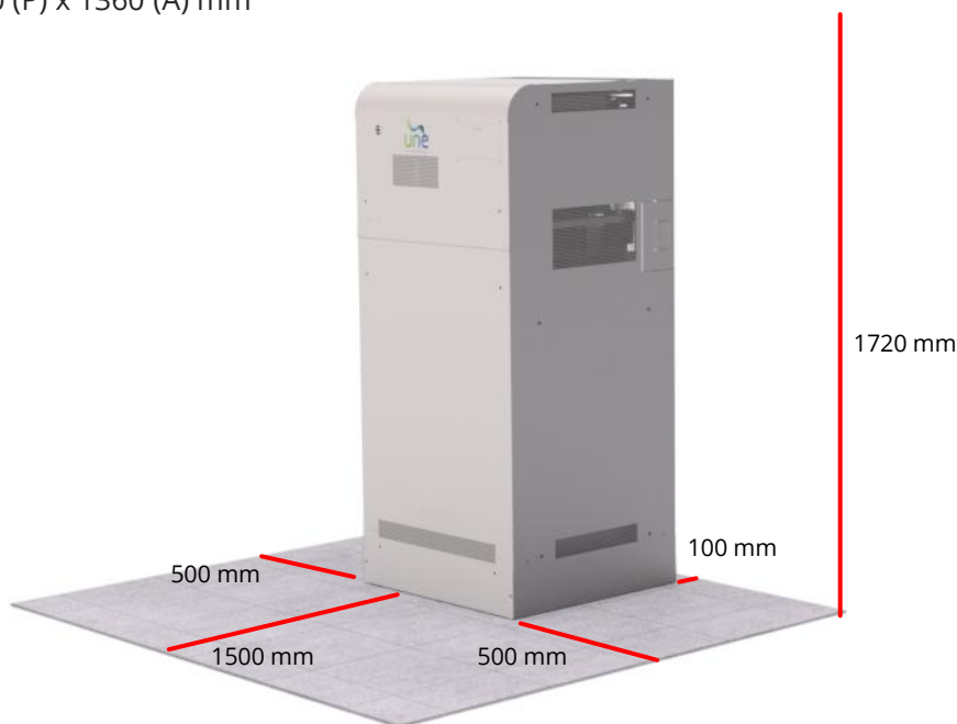
Figura 20 – Distanze minime di UNE ZHERO S6 per BOX Batterie e Box Inverter
