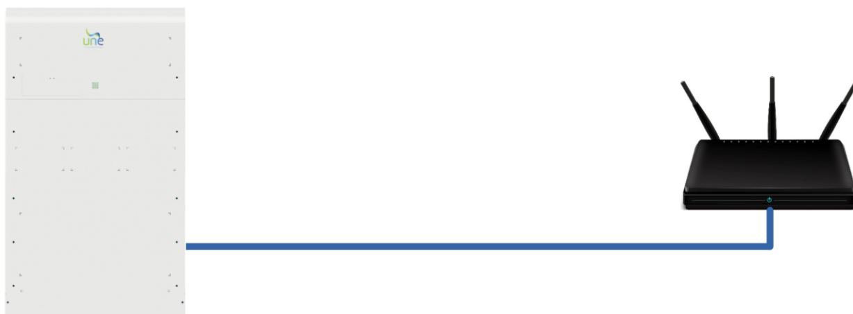
Figura 60 - Collegamento Ethernet diretto
