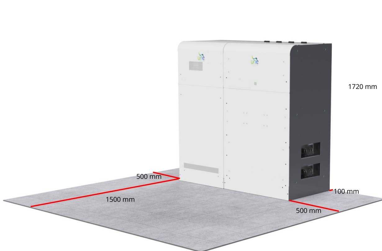
Figura 23 – Distanze minime di UNE ZHERO S10 per BOX Batterie e Box Inverter
