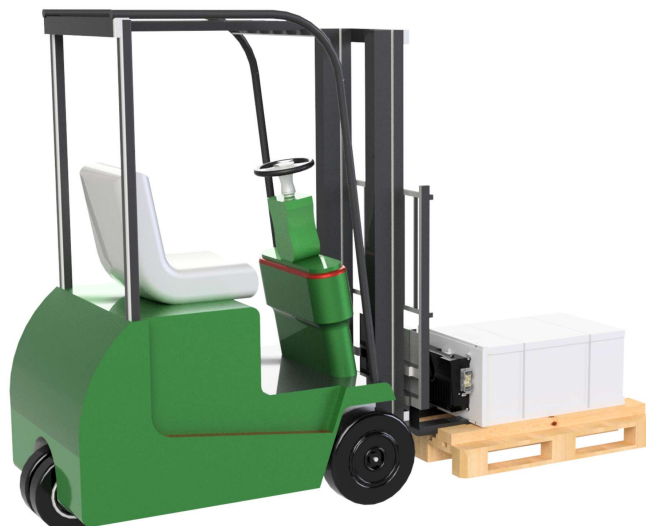
Figura 37 – Posizionare la batteria su un pallet con travi di legno.
