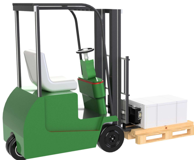
Figura 19 - Inserimento del carrello elevatore tra le travi di legno per sollevare la batteria dal pallet.
