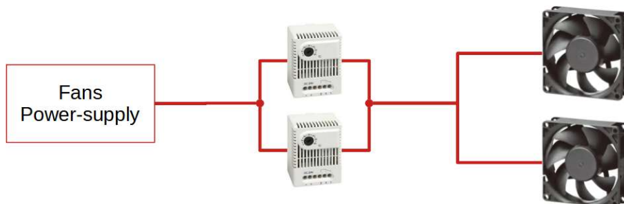
Figura 9 - Ventilatori e termostati
