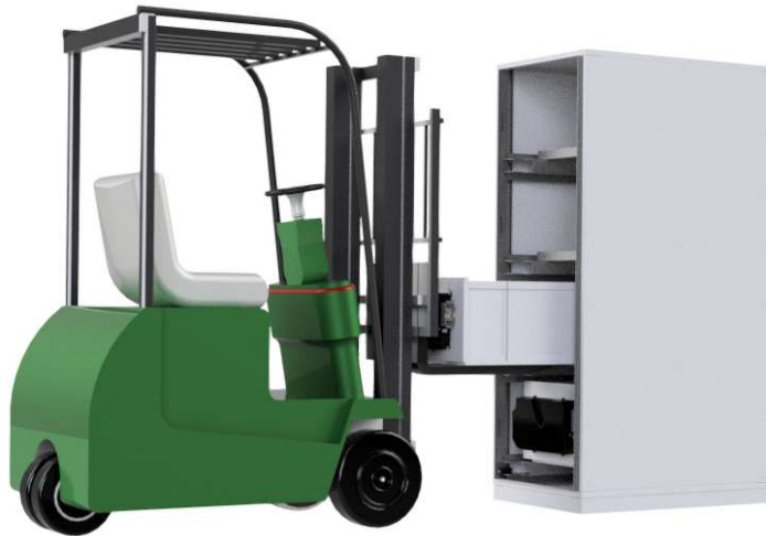
Figura 36 – Batteria spostata con carrello elevatore
